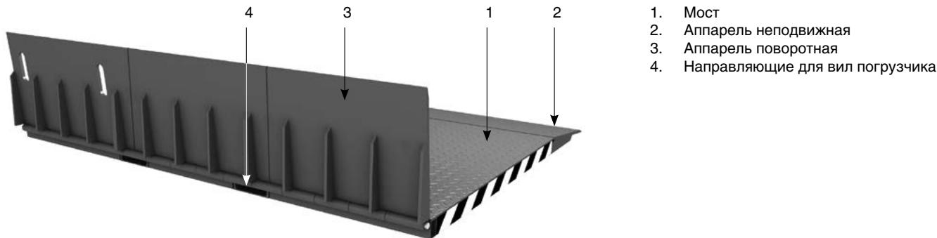
**Примечание:** Поверхность переносного моста представляет собой стальной лист толщиной 5 мм с «чечевичным» рифлением высотой 0,5–1,5 мм. Аппарель изготавливается из стального листа толщиной 12 мм с «чечевичным» рифлением высотой 1,2–3,6 мм. Балки моста изготавливаются из трубы размером 60×40×3 мм. Мост имеет систему для транспортировки, адаптированную под стандартные вилы погрузчика. Возможна небольшая потенциальная деформация поверхности моста, что не отражается на эксплуатации изделия.
