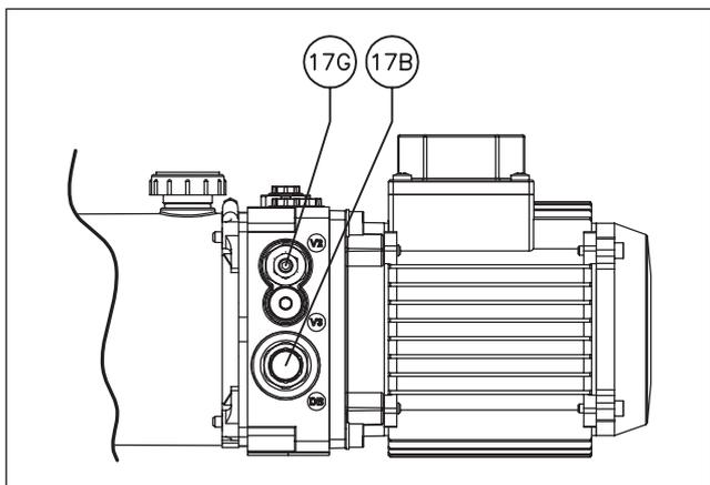
4. Поверните клапан ограничения давления 17b так широко, чтобы платформа лишь слегка приподнялась. Начните с небольшого давления, ок. 100 бар и далее при необходимости поднимайте его.
