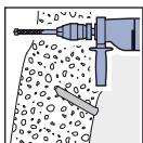
Пробиване на отвори в бетон
