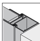
Esecuzione telaio a blocco
